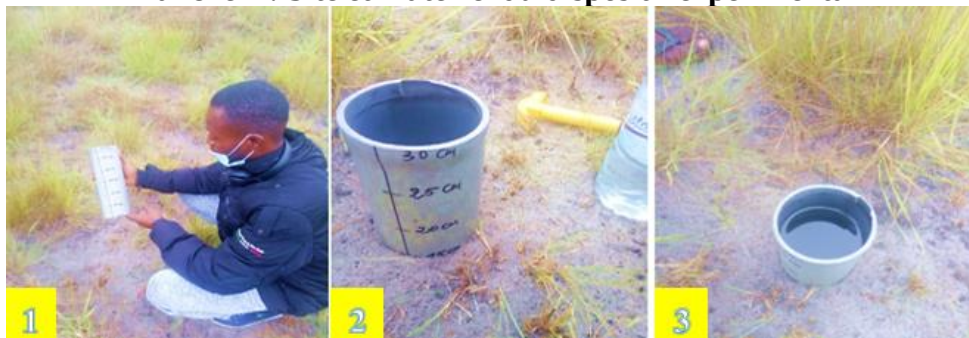
Photo 1 : Tuyau PVC de 30 cm gradué avant installation ; Photo 2 : Dispositif expérimental en place avant les expériences ; Photo 3 : Tuyau PVC rempli d'eau au moment des expériences
