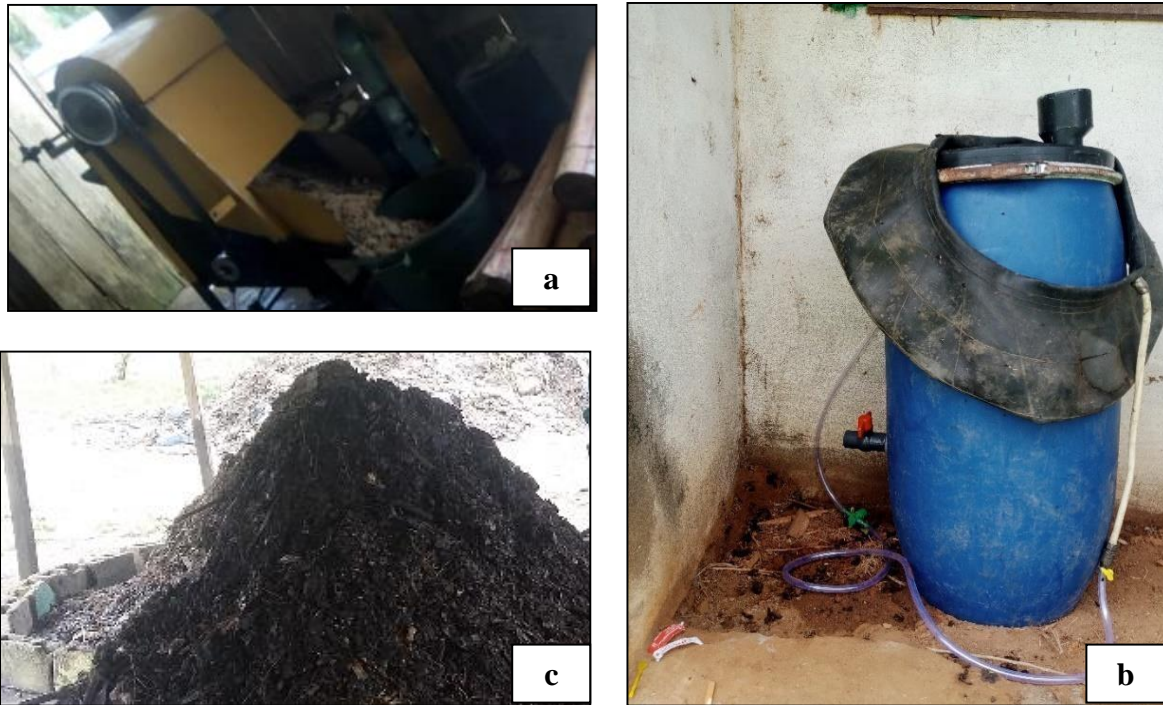
Figure 3 : Dispositifs de valorisation des pseudo-troncs de bananiers (a : Extracteur de fibres ; b : Bio-méthaniseur ; c : Compostage en andain)
